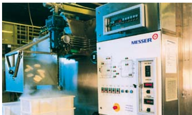
Zamrażanie półwyrobów ciast przy pomocy zamrażarki z przenośnikiem spiralnym Cryogen®-Rapid
