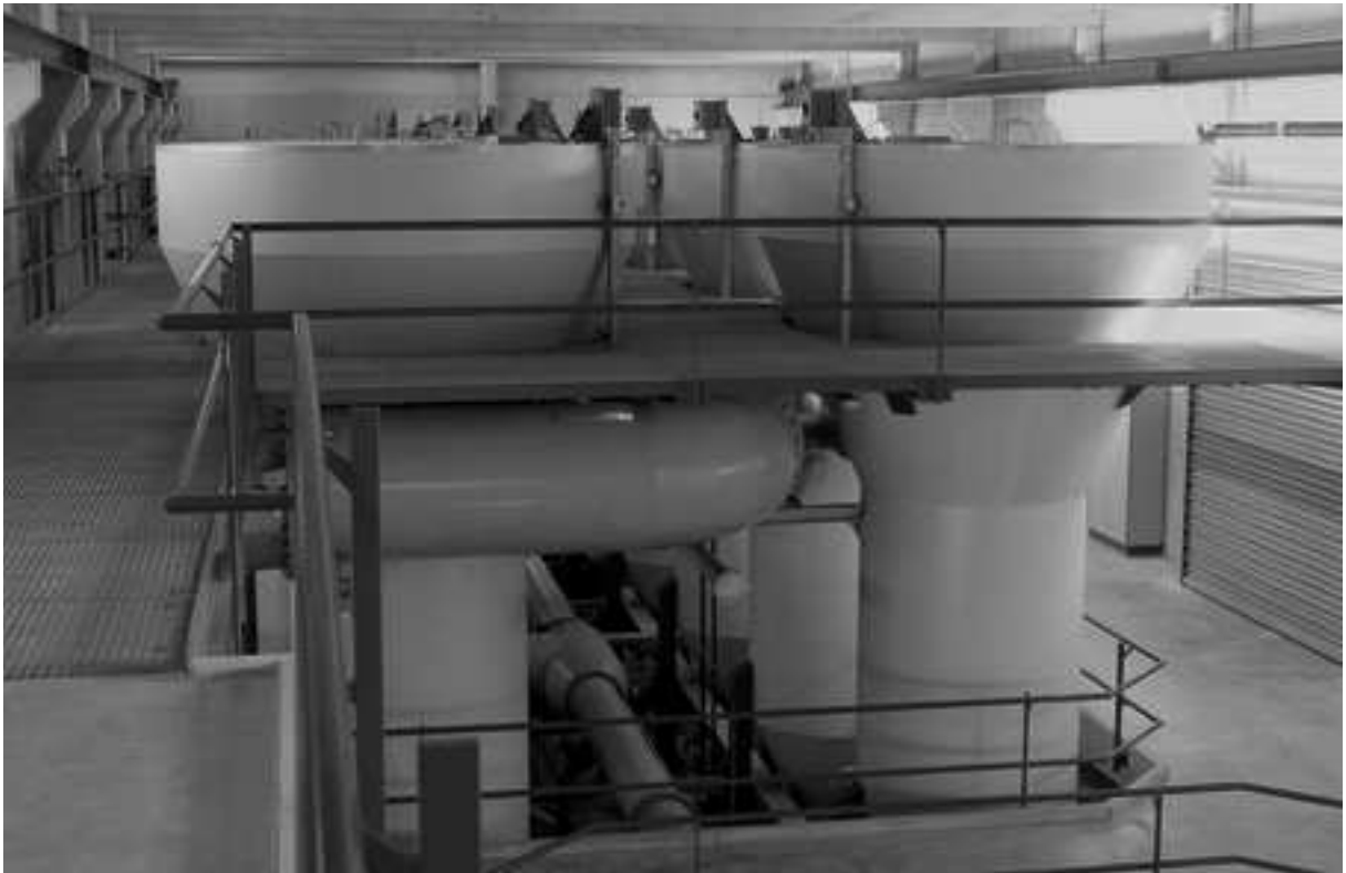
Abb. 5: Schnell-Entkarbonisierung in der Wirbelschicht mit CO 2 -Dosierung am Reaktorausgang
