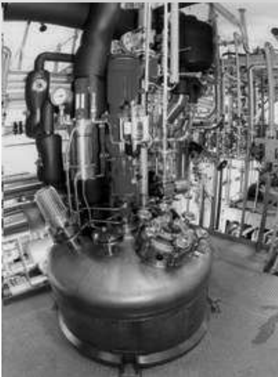
Mischbehälter für Hoch- und Tieftemperaturreaktionen
