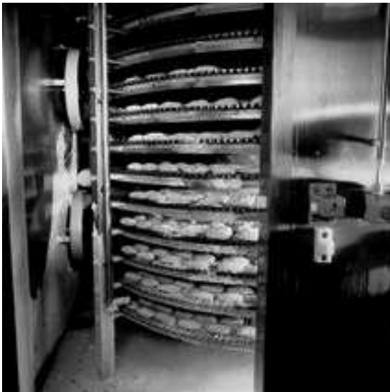
Der Cryogen-Rapid®-Wendelbandfroster erzielt große Gefrierleistung auf engem Raum.
