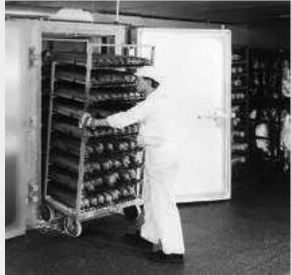
Abb. 8: Für chargenweisen Betrieb und Frostleistungen von 100 bis 1000 kg/h: der Cryogen-Rapid®-Schranksfroster
