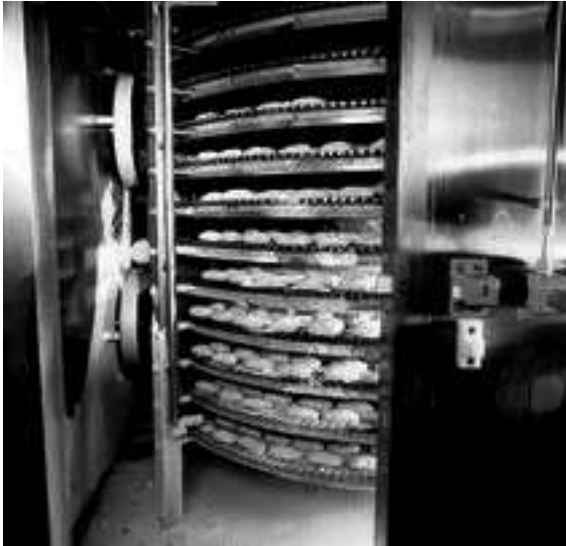
Abb. 7: Hohe Gefrierleistung auf wenigen Quadratmetern – das ist der Vorteil des Wendelbandfrosters.
