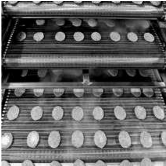
Der Cryogen-Rapid®-Langtunnel eignet sich zum kontinuierlichen Kühlen und Frostern von Lebensmitteln.
