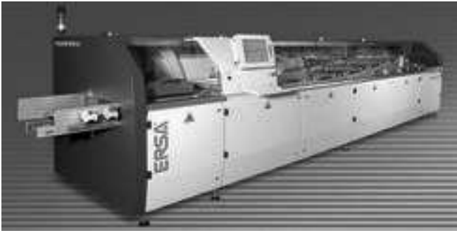
Moderne Schutzgas-Wellenlötanlagen wie die „powerflow“ von ERSA repräsentieren eine neue Maschinengeneration, die alle Aspekte der modernen Fertigung vereint. (Foto: ERSA)
